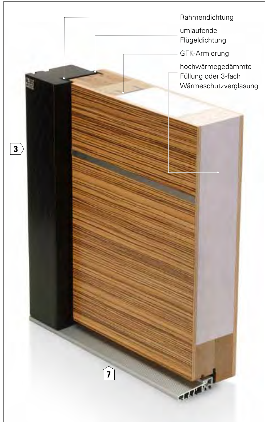
Abb. = Türblattkonstruktion. Modellabhängig bedingt kann auch eine Rahmenkonstruktion erforderlich sein.
